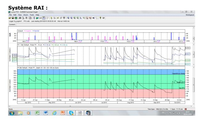
La première irrigation a été déclenchée mi avril, la réserve hydrique est à ce moment-là en au milieu de la RFU. Mi mai, la sonde est tombée en panne, l'irrigation a donc été calée grâce au suivi de la parcelle BI Golden. Le boitier a été remplacé en juillet et équipé d'une batterie ce qui permet de ne plus perdre de données lors de l'usure des piles.
