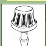
Un mécanisme statique avec déflecteur ou système turbulent (vortex)
